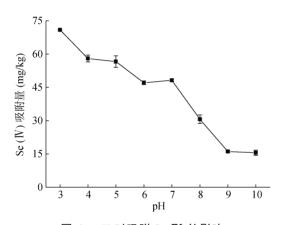
图 6 pH 对吸附 Se(IV)的影响 Fig. 6 Effect of pH on Se (IV) adsorption
