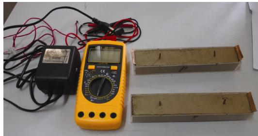
图 2 土样盒电阻率测量装置
