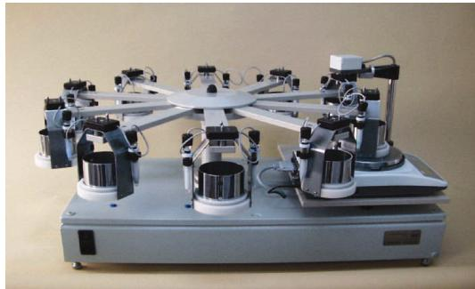
图 1 Ku/pF 非饱和导水率测量系统
